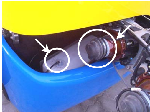
Rys. 15.26 Odchylenie reflektora umożliwiające dostęp do zbiorniczka spryskiwaczy i żarówek lamp reflektorów przednich
