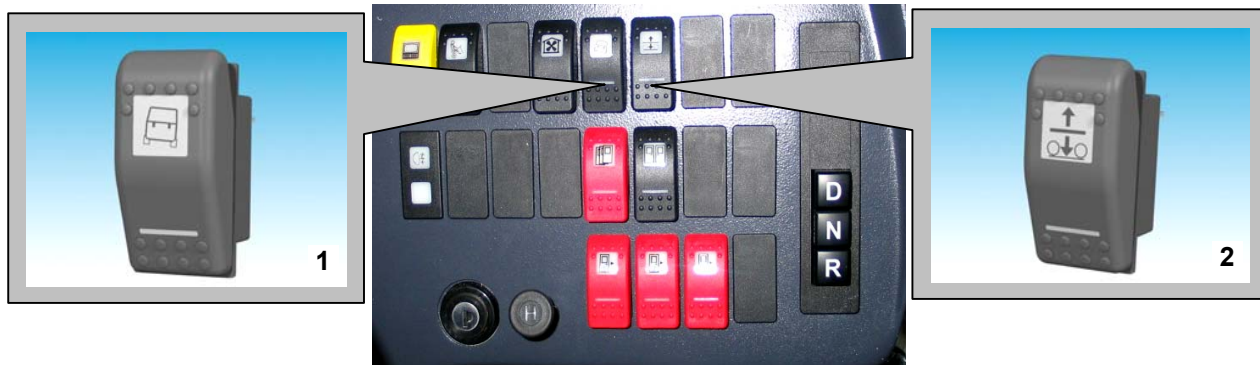
Rys. 10.2 Przyciski związane z zawieszeniem pneumatycznym; 1 – przykłąk prawej strony autobusu, 2 – podnoszenie autobusu
