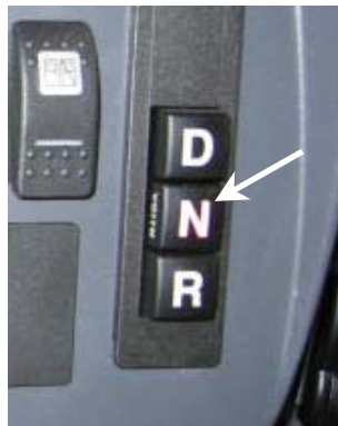
Rys. 5.1. Zespół przełączników skrzyni biegów – wskazany strzałką; D – jazda do przodu, N – pozycja neutralna (luz), R – jazda do tyłu
