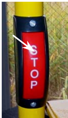
Rys. 24.6 Przycisk "stop" sygnalizuje kierowcy konieczność zatrzymania się na najbliższym przystanku
