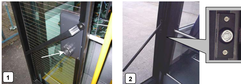
Rys. 16 Zamki ryglujące od środka, pokrętło ryglujące – 1, zamek kwadratowy ryglujący – 2
