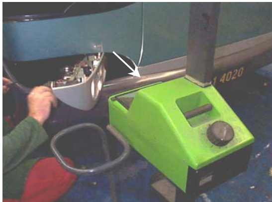
Rys. 15.15 Przyrząd nastawczy do regulacji ustawień reflektorów – kierunek obserwacji zgodny z okienkiem nastawczym przyrządu wskazany strzałką
