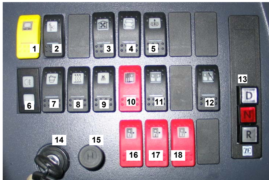
Rys. 15.7 Zespół przełączników znajdujących się na desce rozdzielczej kierowcy, po prawej jej stronie
