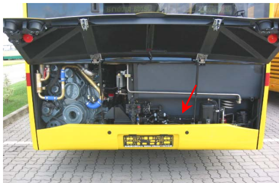
Rys.18.1 Umieszczenie pieca ogrzewania dodatkowego i zaworów układu ogrzewania – wskazane strzałką
