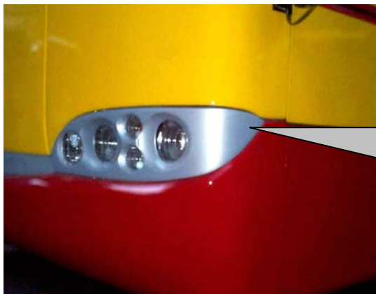
Rys. 15.25 Dźwigienka zwalniająca mocowanie zespołu reflektorów przednich – wskazana strzałką
