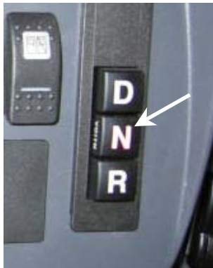
Rys. 4. Sterownik automatycznej skrzyni biegów: D – jazda do przodu, N – luz, R – jazda do tyłu (deska rozdzielcza kierowcy)
