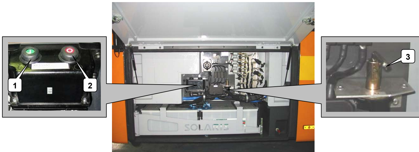
Rys. 15.11 Zewnętrzna kłapa obsługowa akumulatorów: 1 – przycisk awaryjnego wyłącznika zasilania, 2 - przycisk awaryjnego wyłącznika zasilania, 3 –wyłącznik masy
