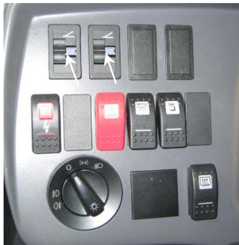
Rys.18.8 Przełączniki sterowania klap dachowych (lewa strona deski rozdzielczej kierowcy)
