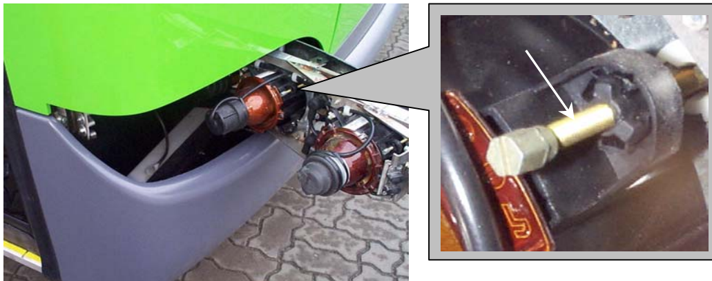
Rys. 15.14 Widok uchylonej klapy zewnętrznej umożliwiającej dostęp do reflektorów – strzałką wskazana śruba nastawcza reflektorów
