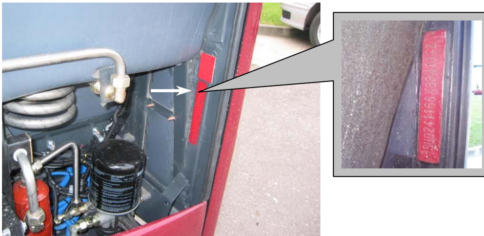
Rys. 2. Numer nadwozia – wskazany strzałką (komora silnikowa)
