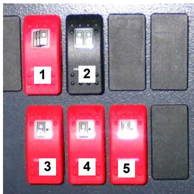
Rys.24.7 Przyciski na desce kierowcy związane z obsługą drzwi: 1 – otwieranie i zamykanie wszystkich drzwi, 2 – pozwolenie otwarcia drzwi przez pasażerów, 3,4,5 – otwieranie i zamykanie kolejnych drzwi,
