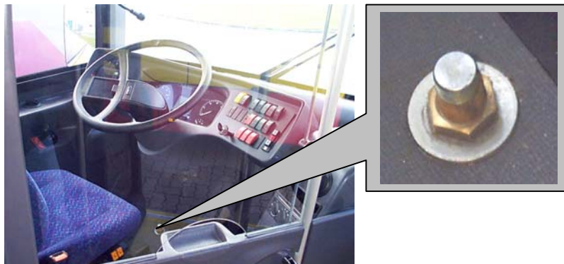
Rys. 12.1 Zawór pneumatyczny przestawiania kolumny kierownicy wraz z deską kierowcy
